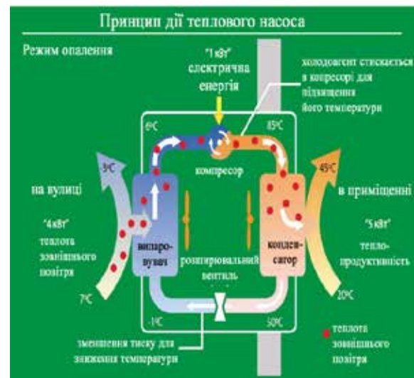
Рис. 1. Схема компресійного теплового насоса «повітря-повітря»
